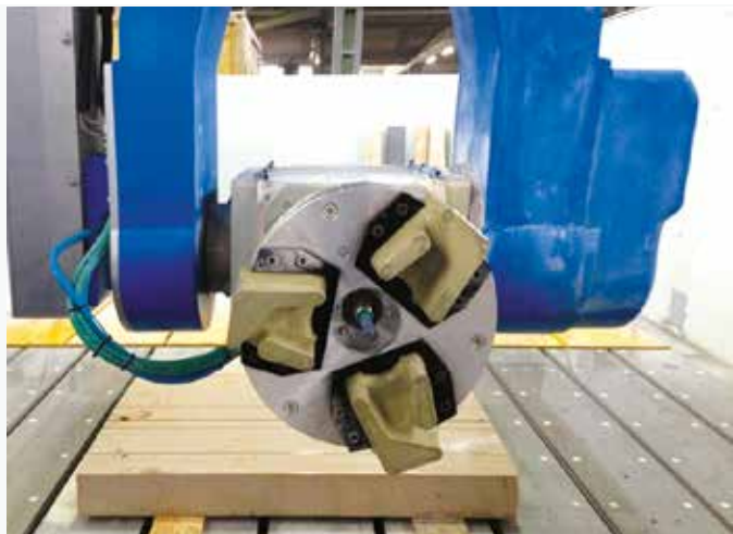
Segmentos Frankfurt de 300 mm de Ø para el tratamiento de superficies de piedra natural.
