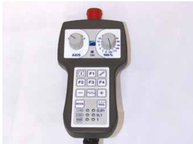
Panel de control remoto para controlar hasta 6 ejes lo que permite operar cerca de la superficie de corte y configurar múltiples orígenes.
