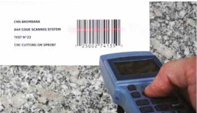
Lector de códigos de barras suministrado con software dedicado para leer el código y recuperar el programa de mecanizado.
