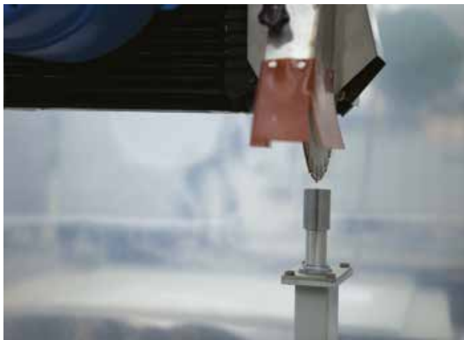
Sistema de preajuste de disco para medir el diámetro del disco y la longitud de las cortadoras/sierras de calar.
