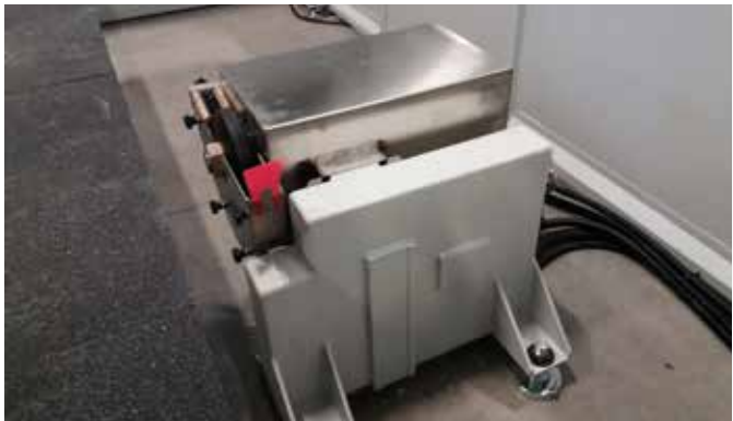
Unidad de corte desde abajo para realizar incisiones en la cara inferior de la losa, con el fin de insertar los refuerzos para las encimeras de cocina. También ampliable con unidad de perforación desde abajo, para la creación de orificios ciegos dedicados a las fijaciones para encimeras de cocina/baño. Las operaciones son gestionadas automáticamente por la máquina y requieren el uso del manipulador de ventosas.
